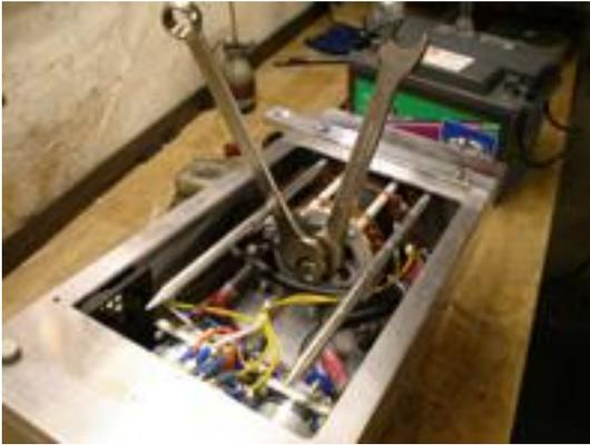
Den Windenboden aufschrauben, Die beiden Muttern M 12 (SW 19) hinter der Regelung mit zwei Maulschlüsseln halten, die erste Mutter lösen, die an der Regelung anliegende Mutter eine halbe Umdrehung weiter anziehen, die Kontermutter herandrehen und beide Muttern gut festziehen.
