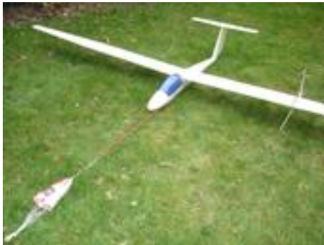
Startseil mit Fallschirm und Großseglerstarthilfe
